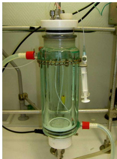
Figura 2. Reactor sonoquímico utilizado en la degradación de NPX. Condiciones: Frecuencia 630 kHz, potencia 20-60W y volumen 300 mL.
