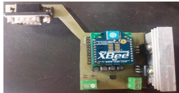
Figura 8. Módulo de alimentación y transmisión para el Xbee
